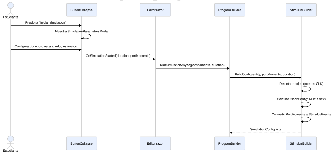
Figura 5.33: Diagrama de secuencia: configuracion de simulacion. StimulusBuilder convierte los parametros de la interfaz al formato SimulationConfig del motor. Nota: se omiten acentos y caracteres especiales por compatibilidad con Mermaid.
